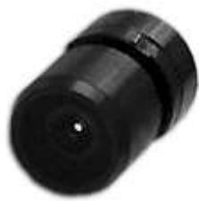
Широкоугольный микрообъектив ОЛ-М1 (микрообъектив 1 mm F/3.0) разработан для использования в видимом оптическом диапазоне 400-700 нм. Он обеспечивает угловое поле зрения 120 градусов. Объектив ОЛ-М1 имеет фиксированный фокус 1 мм. Миниатюрные размеры D5x8(7) мм позволяют использовать наши объективы в различных эндоскопических приборах.
